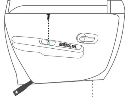
Com uma espátula fina, retire a tampa dos parafusos. Em seguida retire os parafusos para retirar o forro da porta e iniciar a instalação.
