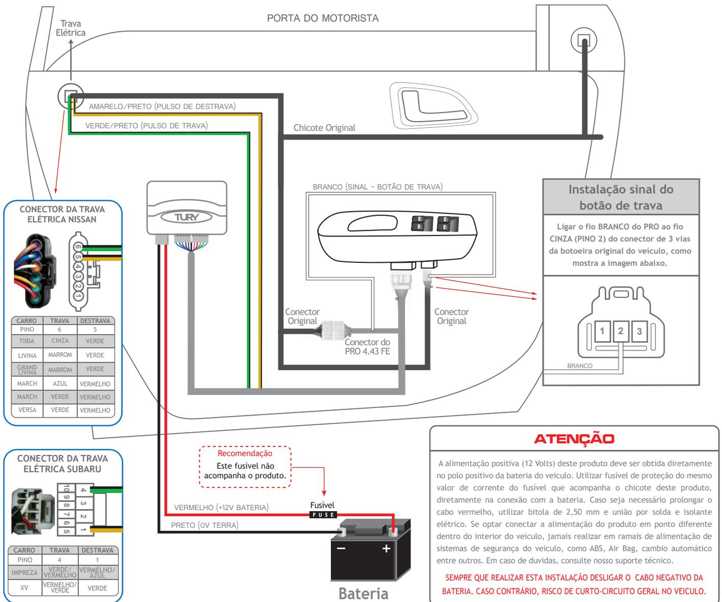
As cores dos fios originais e suas funções e localizações podem variar. Com um multímetro sempre verifique antes de instalar nossos produtos, para evitar possíveis problemas. A TURY não se responsabiliza por danos causados no sistema elétrico do veículo por falhas de instalação.
