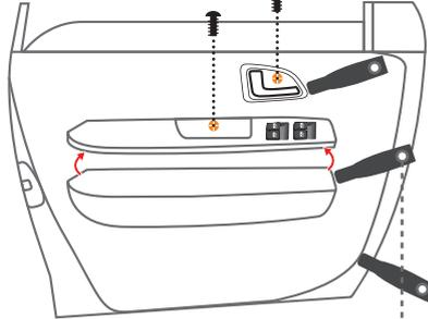
Abra "o apoio-braço" e a moldura da maçaneta com cuidado, utilizando uma espátula fina, para localizar os parafusos.
